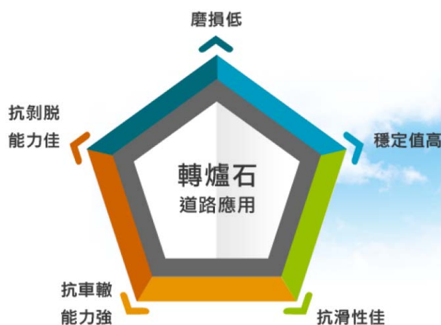
圖12 轉爐石應用於瀝青混凝土鋪面之優點
