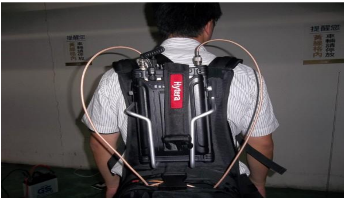
圖 6-35 背負式無線電轉播機測試實景（二）
