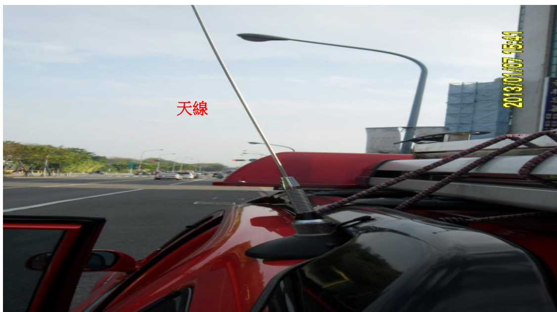
圖 6-9 模式一地面層天線架設實景
