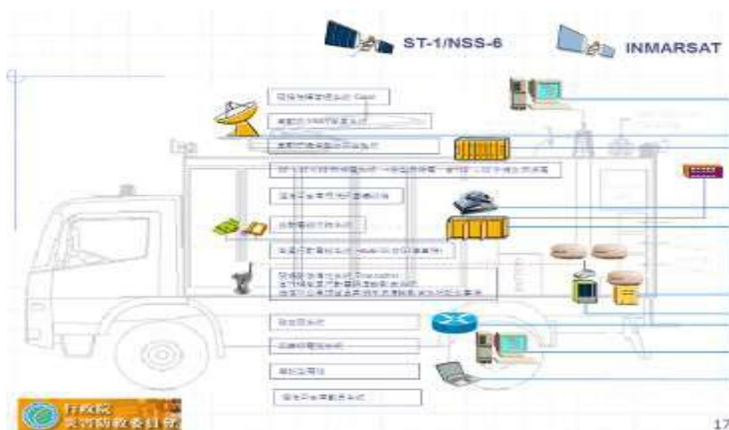
圖 3-20 車載式通信整合平臺系統示意圖
