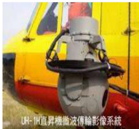
圖 3-19 UH-1H 單螺旋槳直升機攝影機空拍系統圖
