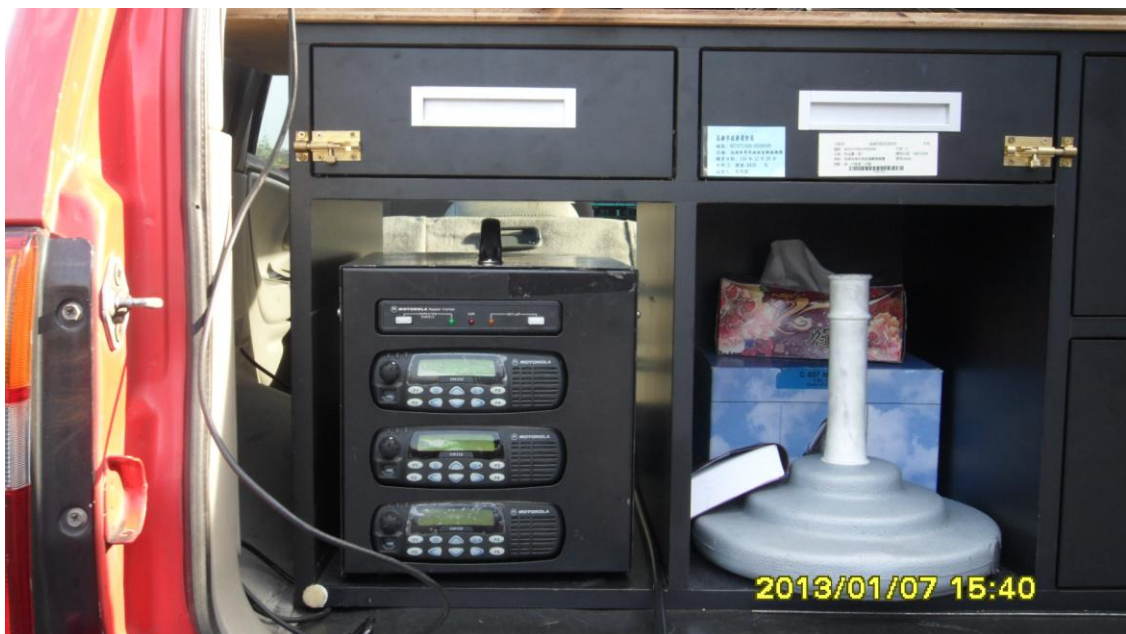
圖 6-5 無線電轉播機留置指揮車上測試實景
