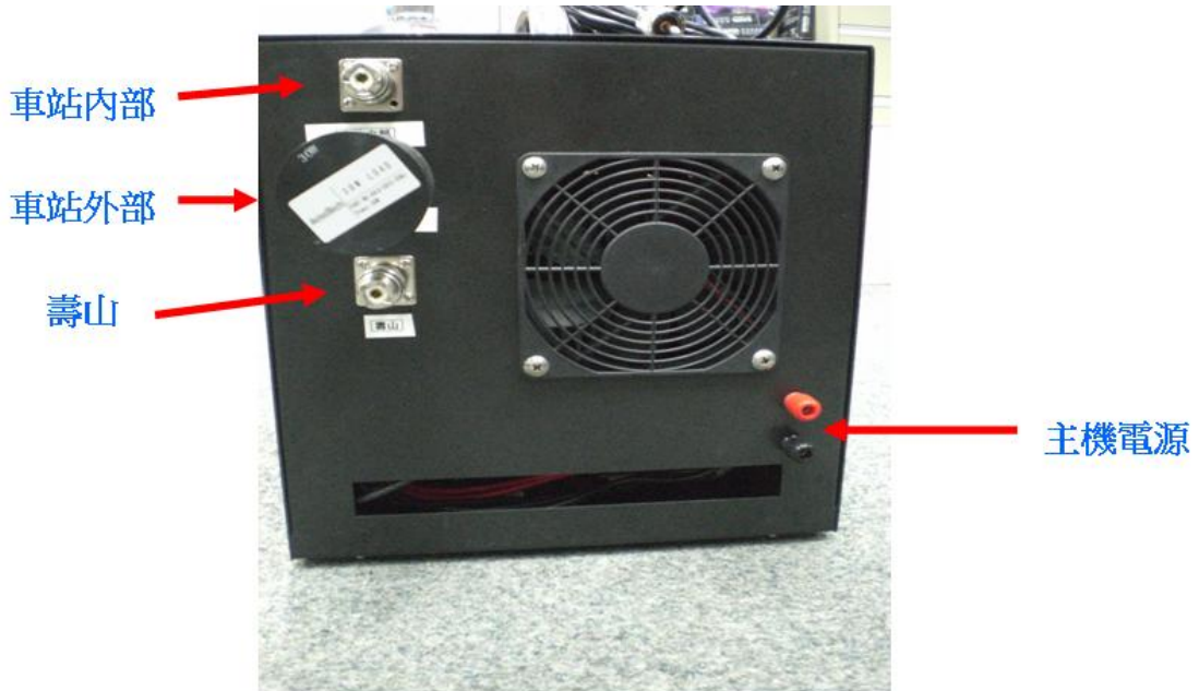
圖 4-3 高雄捷運移動式無線電轉播機 (背面)
