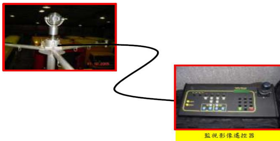
圖 3-17 車外影像監控系統(CCTV)示意圖
