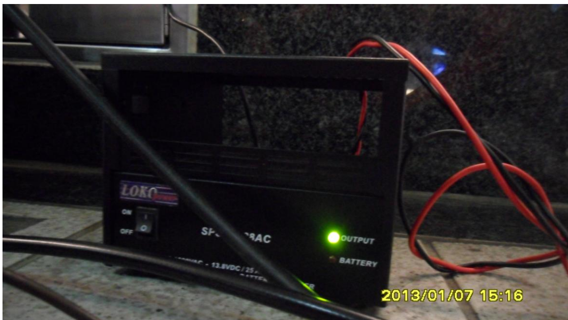
圖 6-14 模式二無線電轉播機連接電壓轉換器測試實景
