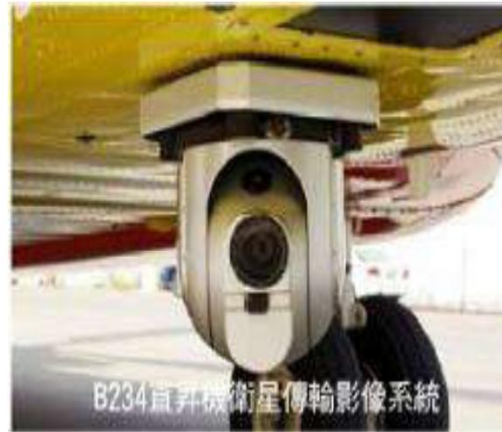
圖 3-18 B-234 雙螺旋槳直升機攝影機空拍系統圖
