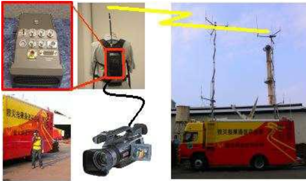
圖 3-16 無線數位影像訊號傳輸系統路徑圖
