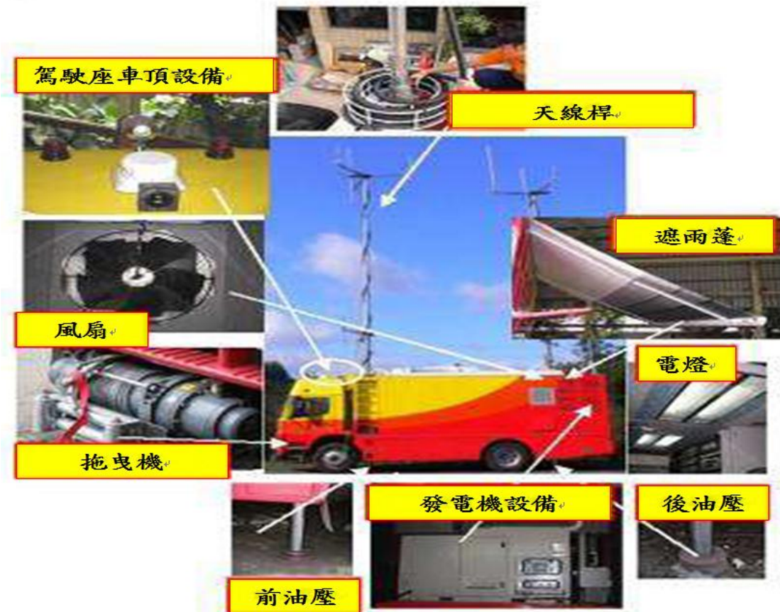
圖 3-10 救災指揮通信平臺車之設備概要圖
