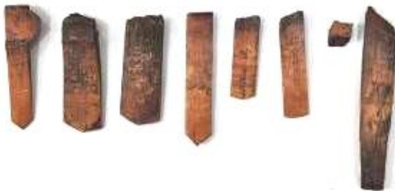
照片 3-116 杉木母屋構材各式各樣的竹釘
