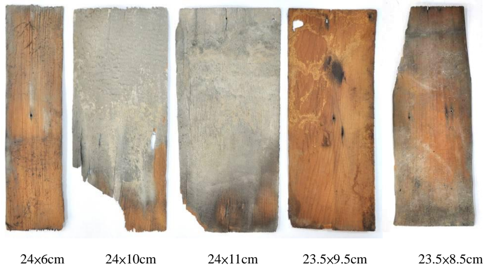
照片 3-115 木瓦板尺寸大小（厚度為 2-3mm）
