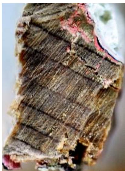
照片 3-104 臺灣扁柏大門門框構材之橫切面細胞
