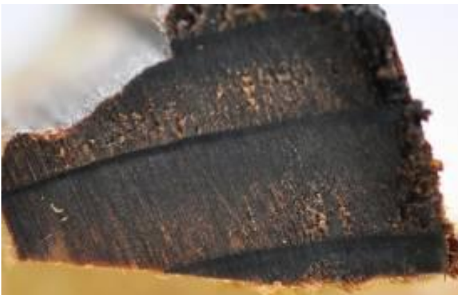
照片 3-105 杉木釣木之橫切面年輪觀察 照片 3-106 杉木母屋構材之橫切面細胞
