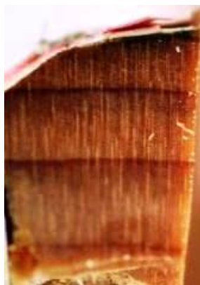
照片 3-101 紅檜 窗框構材之橫切 面細胞
