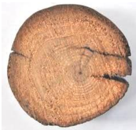
照片 3-105 杉木釣木之橫切面年輪觀察 照片 3-106 杉木母屋構材之橫切面細胞
