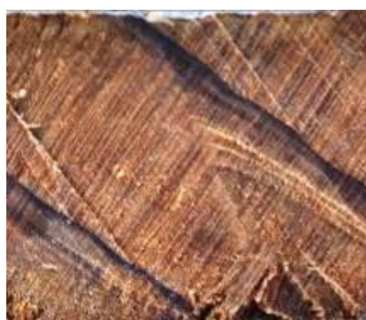
照片 3-107 杉木合掌構材之橫切面細胞 照片 3-108 杉木合掌構材之徑切面細胞 照片 3-109 杉木屋面板構材之橫切面細胞
