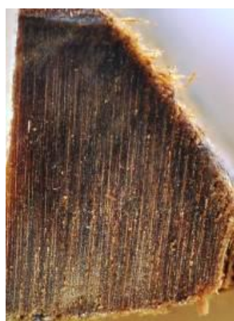
照片 3-107 杉木合掌構材之橫切面細胞 照片 3-108 杉木合掌構材之徑切面細胞 照片 3-109 杉木屋面板構材之橫切面細胞
