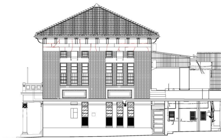
圖 5-12 左（東）面立面損壞-粉刷層龜裂、角隅裂縫
