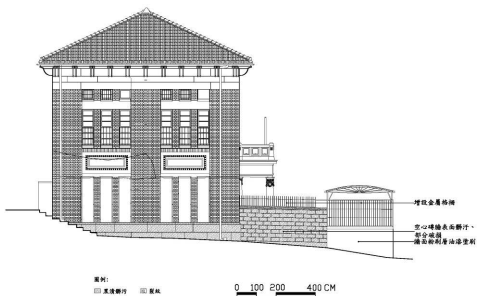
圖 6-35 右側立面圍牆損壞現況圖
