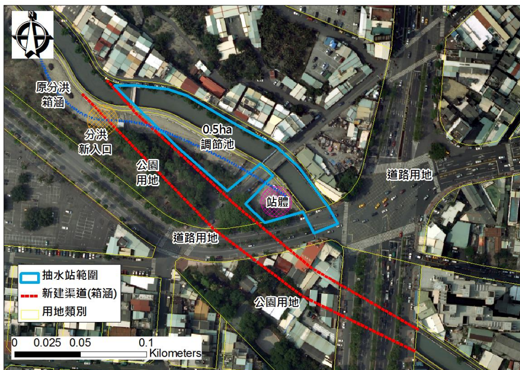
圖 5-38 寶珠溝易淹水區治理對策示意圖-方案二
