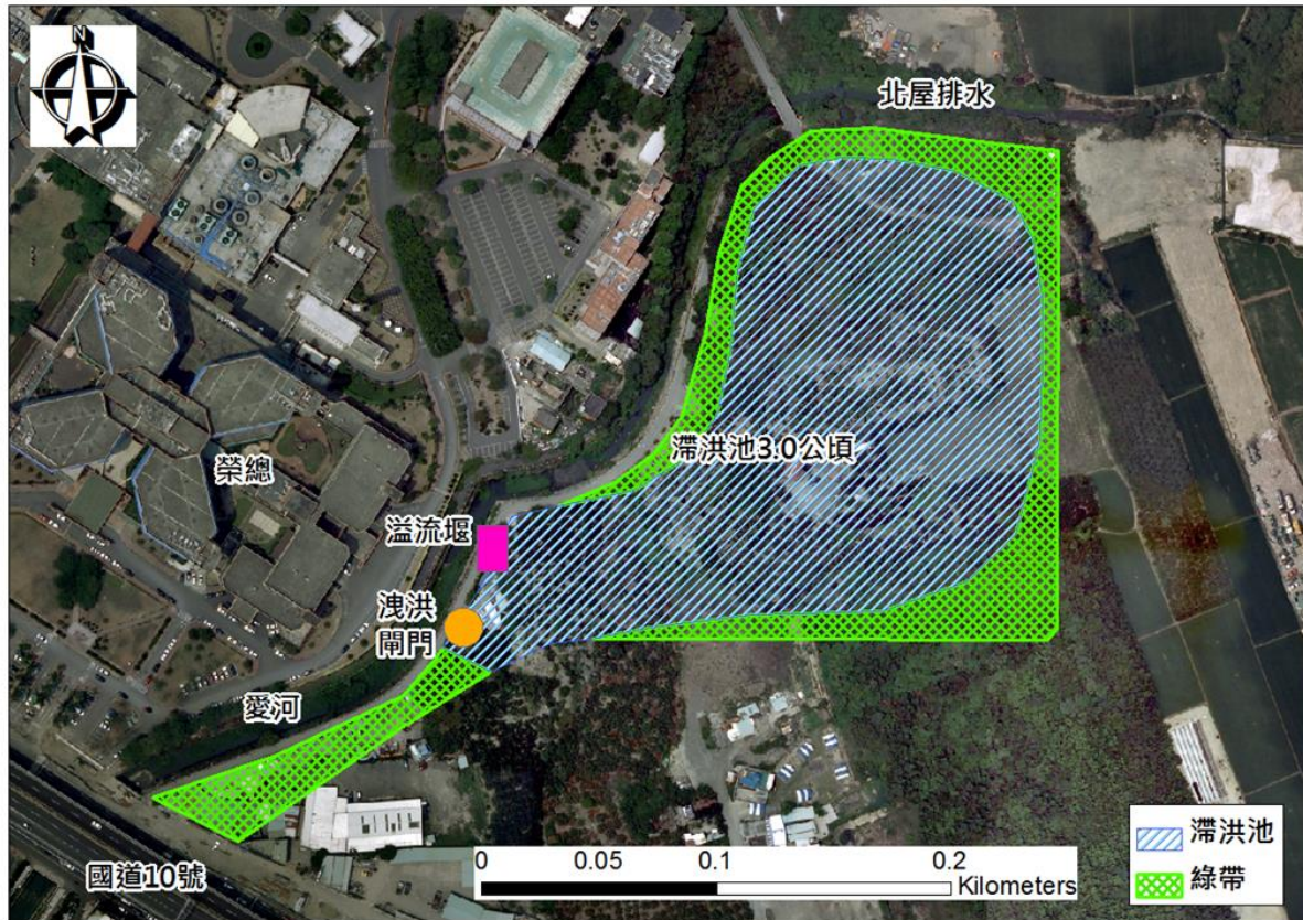
圖 6-29 灣仔內滯洪方案工程配置圖
