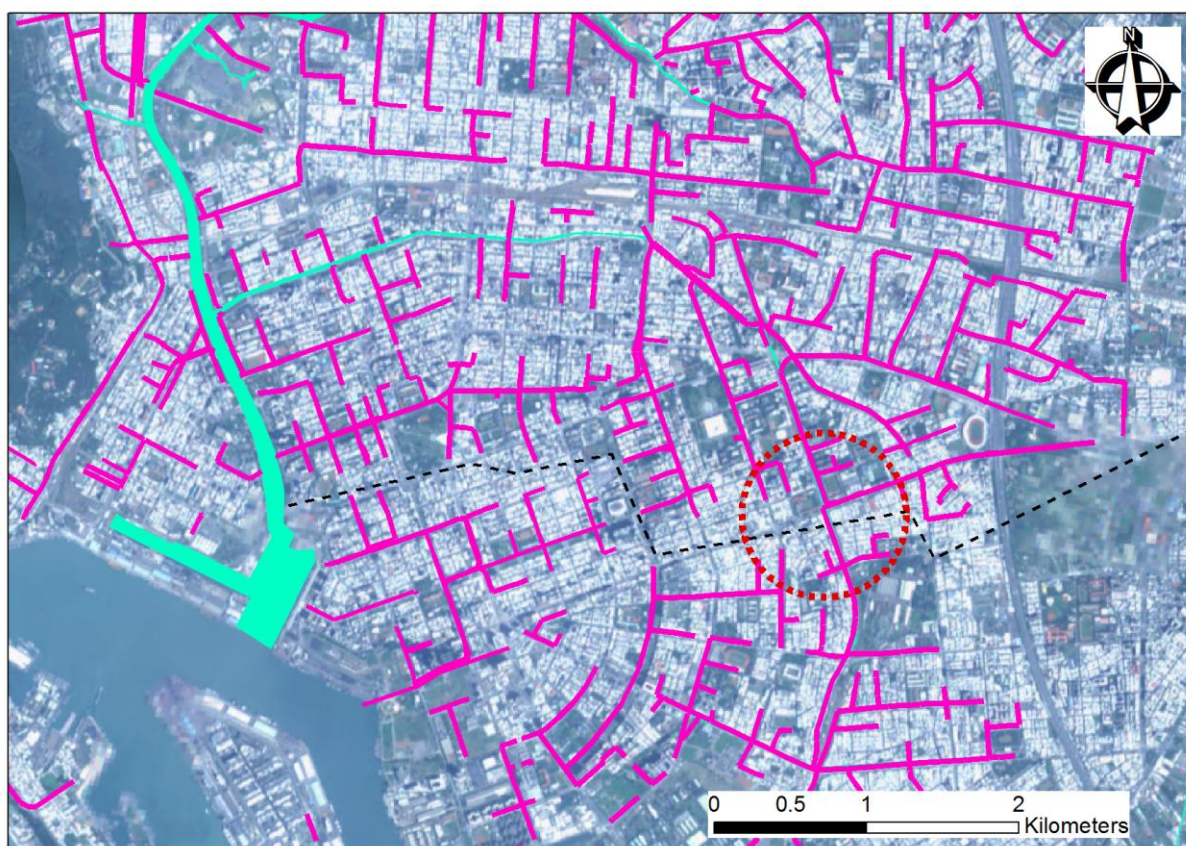
圖 6-8 愛河出口周圍雨水下水道分布圖
