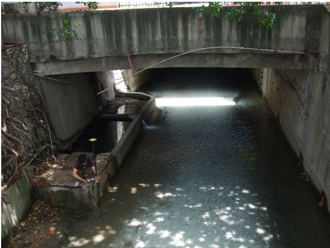
圖 3-62 虛擬參考站衛星定位測量(VRS-RTK)作業情形(鼓山山溝高程測量)
