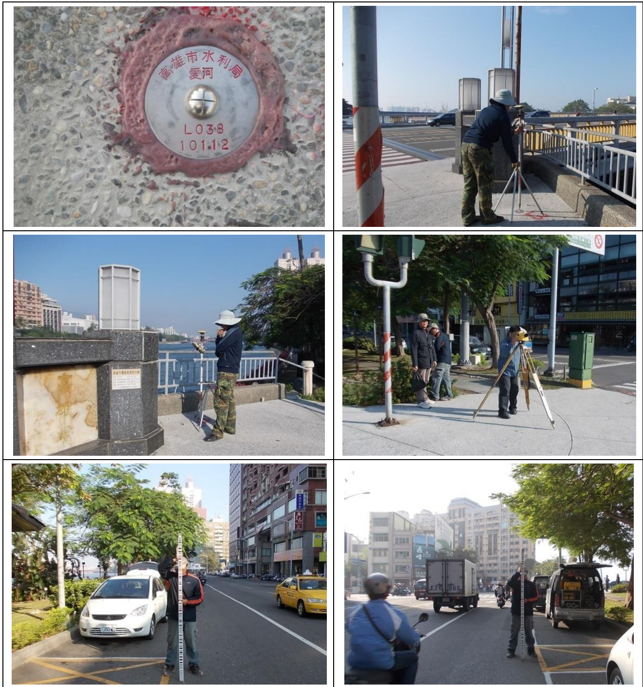
圖 3-79 愛河主河道斷面測量作業
