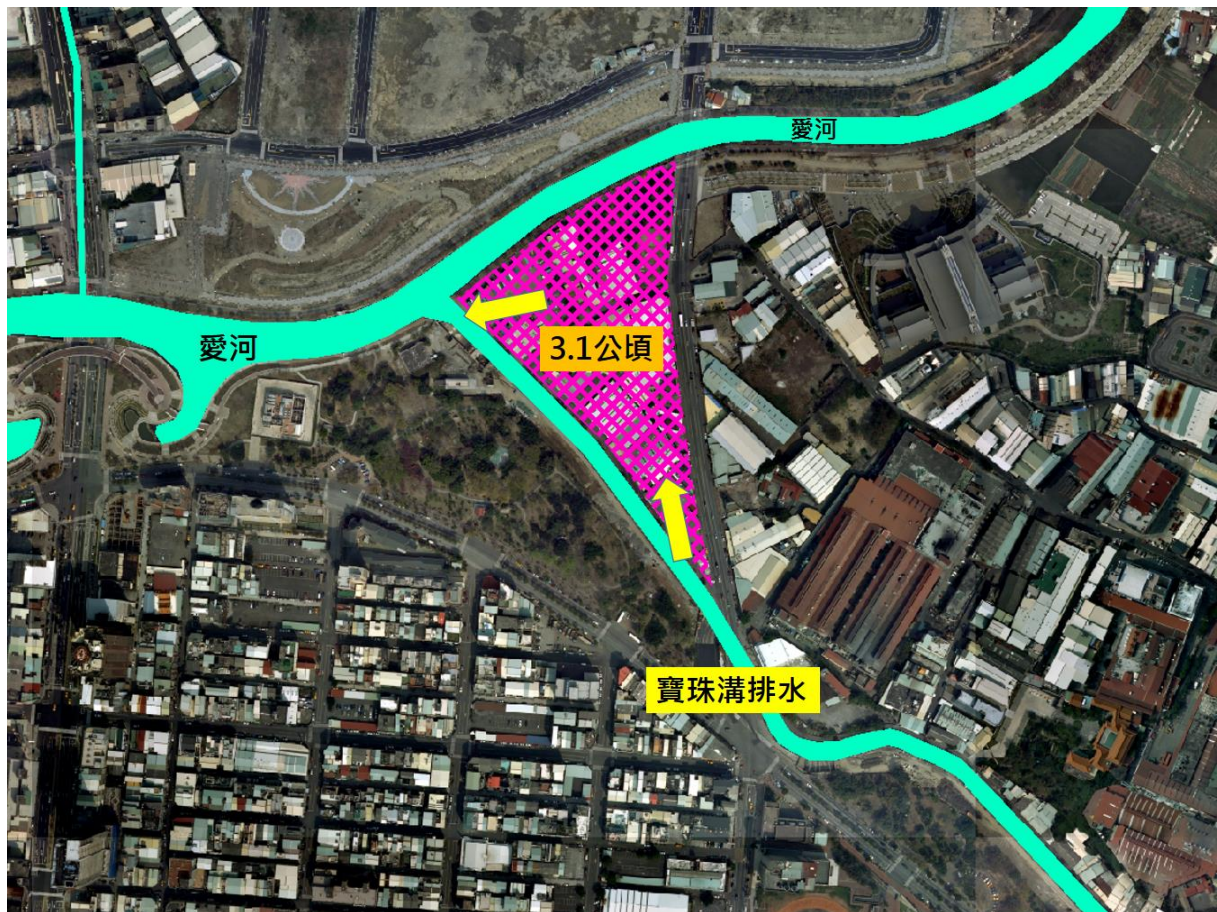
圖 5-36 寶珠溝易淹水區治理對策示意圖-方案一
