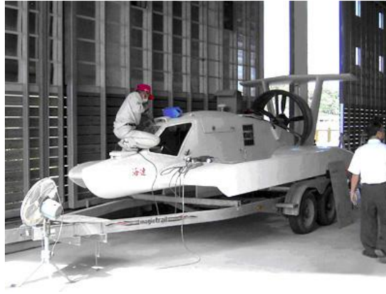
圖 4.2-5 中山科學院研發之飛翼船原型船
